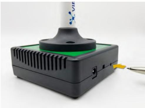
**Abb. 18: Spitzen Gegenstand, wie z.B. Kugelschreiber, in Loch einführen**
