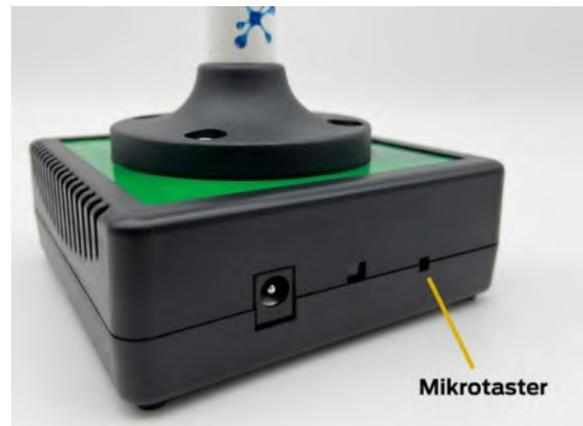
Abb. 9: Position des Mikrotasters
