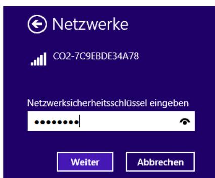
Abb. 21: Verbinden mit WLAN Access Point
