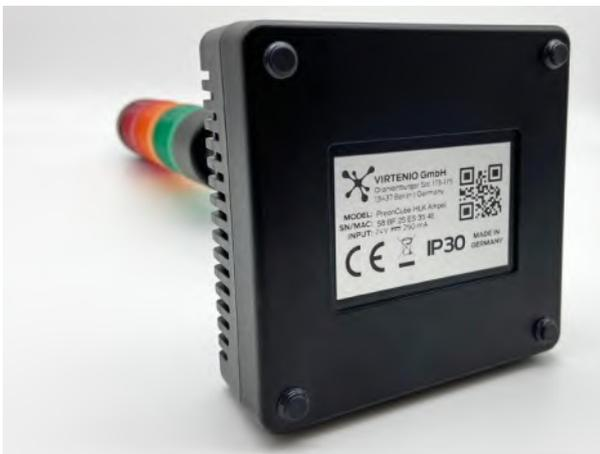
Abb. 1: Position des Typenschildes
