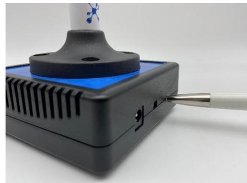
Abbildung 18: Gegenstand mit leichter Kraft an Mikrotaster drücken
