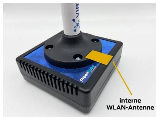
**Abb. 11: Position von interner WLAN-Antenne**
