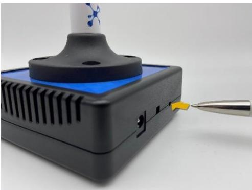
Abb. 17: Spitzen Gegenstand, wie z.B. Kugelschreiber, in Loch einführen
