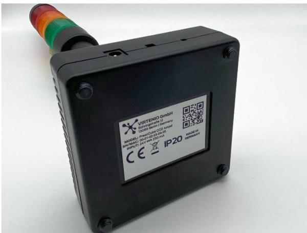
Abb. 1: Position des Typenschildes
